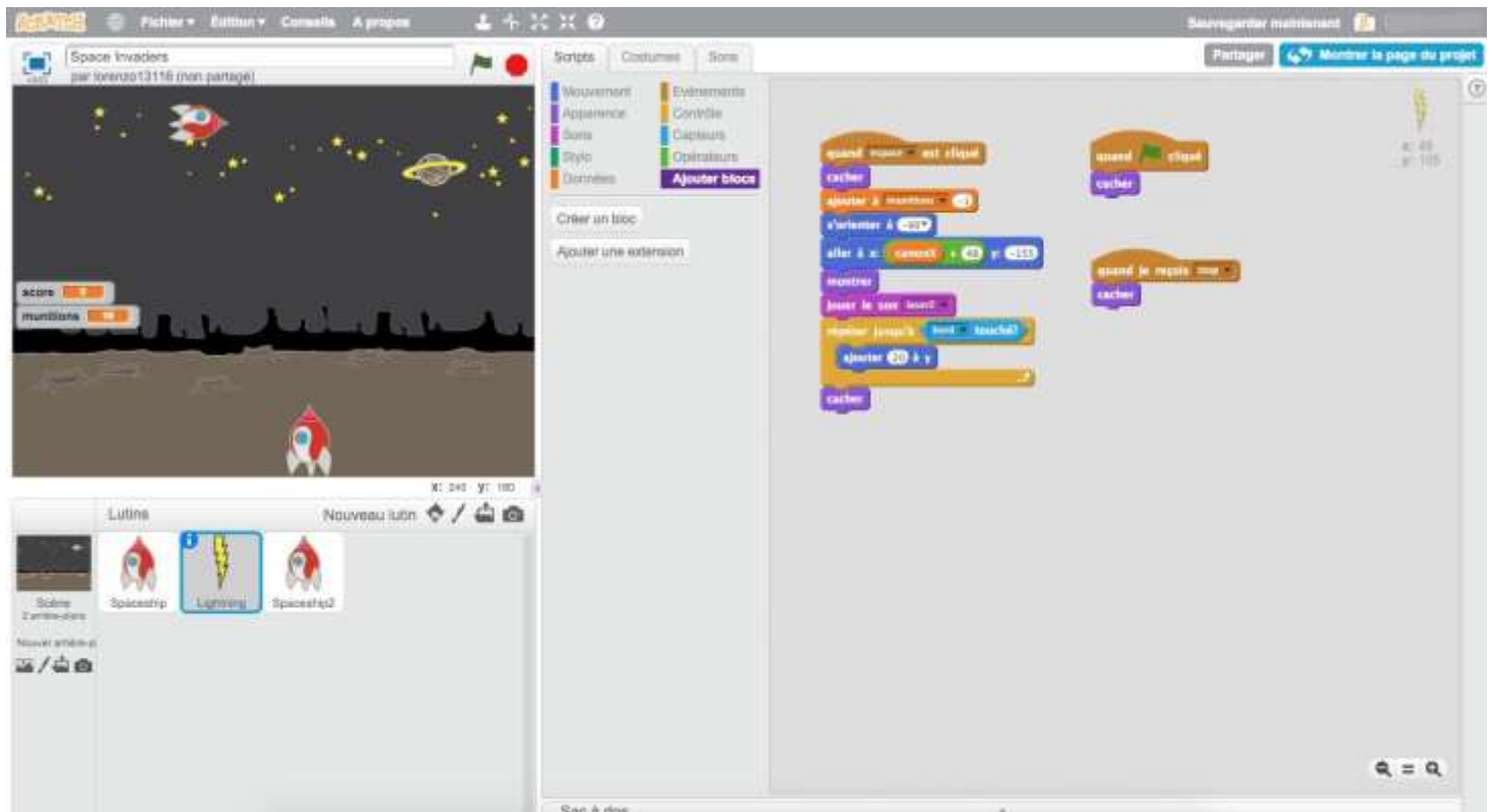
Exemple d'un petit jeu créé avec « Scratch » (à gauche) et des lignes de code simplifiées qui le font fonctionner (à droite).
